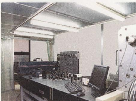
フェムト秒レーザ加工システム：フェムト秒レーザを用いて超精細加工を行うことができるシステムである。加工過程を以下に述べる。① 発振器より出力された波長 780 nm の光を再生増幅器に入射し、パルスエネルギー 1 mJ、パルス幅 150 fsec（半値全幅）のパルスを出力する。② 高調波発生ユニットを用いて第 2 及び第 3 高調波を発生することができる。③ 除振機構を装備した雰囲気制御型チャンバを用い、ガス雰囲気下及び、真空下において加工を行うことができる。④ チャンバ内のコンピュータ制御加工ステージのXYZAB 軸駆動をコンピュータで制御することで、超精細加工を可能とする。
