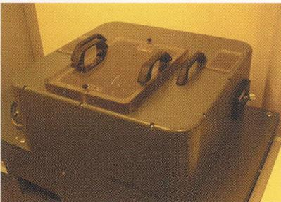
**テラヘルツ分光計測装置**：マイクロメートルオーダーの波長を有するテラヘルツ波の透過特性や反射特性を精密に評価できるスマートアナライザである。測定原理を以下に述べる。① マイクロメートルオーダーの発振用ダイポールアンテナに電圧を印加し、パルス幅  $100\text{fs}$  のフェムト秒レーザーを入射させる。② 電極よりテラヘルツ周波数を成分として含む電磁波パルスが発生するので、これを測定用サンプルに照射する。③ 反射波および透過波を受信用ダイポールアンテナに導き、信号強度の時間変化をフーリエ変換することでスペクトルを得る。
