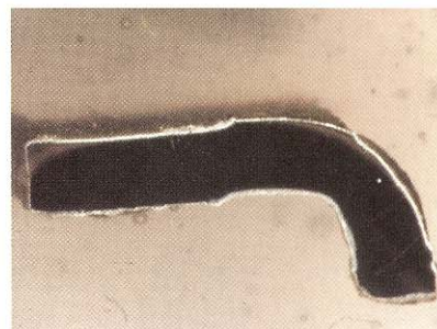
(c) 侵食後ステンレス鋼試料 光学顕微鏡写真
