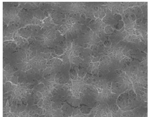
金属ガラス表面に水熱電気化学処理を施すと生体活性層であるチタネートナノメッシュ層が形成されます。（上左図）。本プロセスにフェムト秒レーザーによる自己組織的ナノマイクロ微細構造形成プロセスを組み合わせることで、凹凸構造を有したチタネートナノメッシュ層を形成することに成功しました。（上右図）当金属ガラスに対し擬似生体液浸水試験を行った結果、優れた生体活性機能を有することがわかりました。これら凹凸構造を有したチタネートナノメッシュ層形成技術及び当技術を適用し開発された生体活性機能を有する金属ガラスは、大阪大学接合科学研究所、東北大学金属材料研究所および東京工業大学応用セラミックス研究所による三大学連携プロジェクト（次頁に詳細説明）の成果です。
