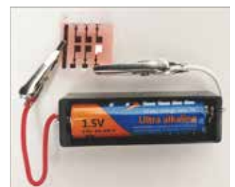
図3 乾電池1本で発光する有機EL (Adv. Opt. Mater. 2022)
