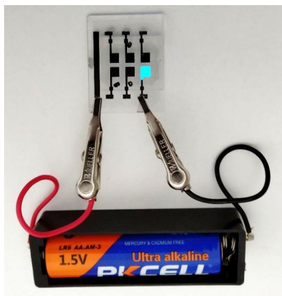
乾電池（1.5 V）1本で青色有機ELを光らせている写真
