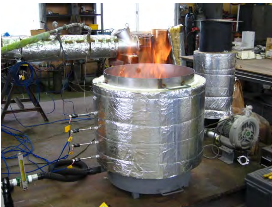
Fig. バッチ式自己燃焼装置(処理能力;35~45kg/hr)
