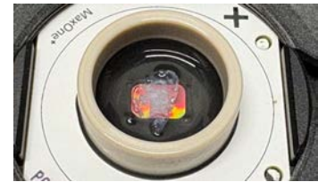
Fig. 4 コラーゲングル薄膜を電極部分に配置した MaxOne MEA (状態③ + Nb+培地 100 \mu L)
