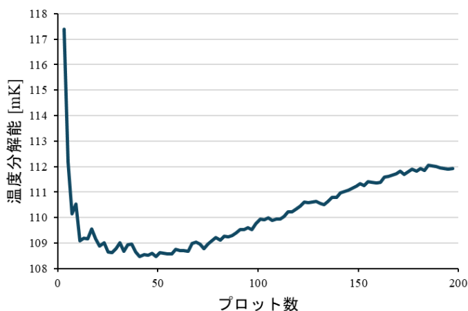
図2. 取得するプロット数と1秒あたりに達成可能な温度分解能の関係
